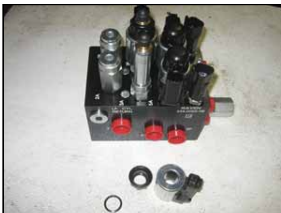
Рис. 13. Из клапана AutoBoom извлечена катушка.
