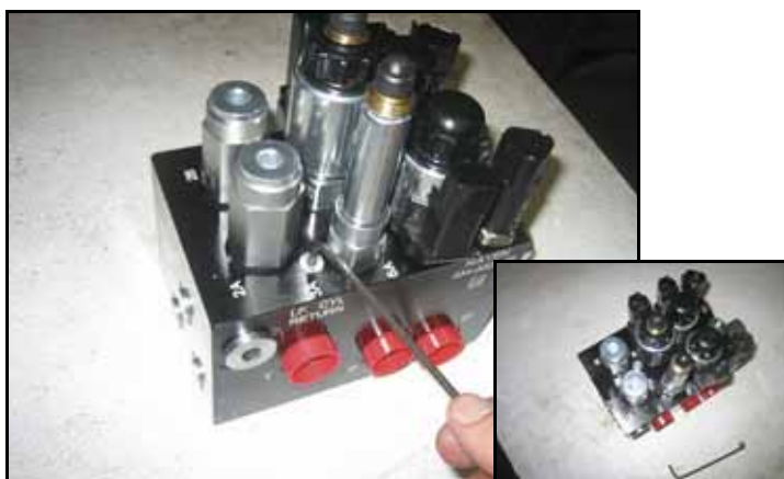
Рис. 14. Из клапана AutoBoom извлечены заглушки портов.
