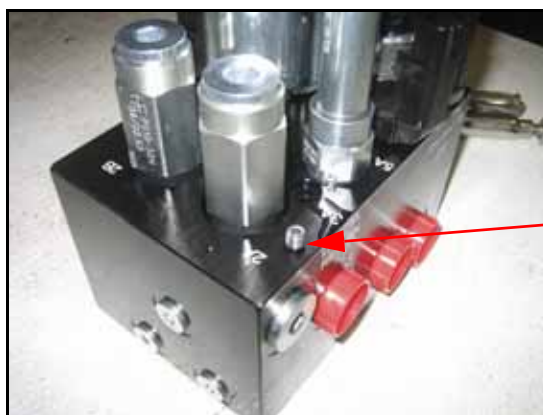
Рис. 15. Из клапана AutoBoom извлечены фитинги отверстий
