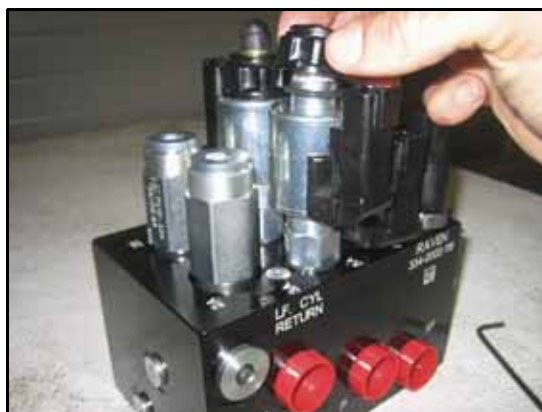
Рис. 17. На клапане AutoBoom повторно установлена катушка
