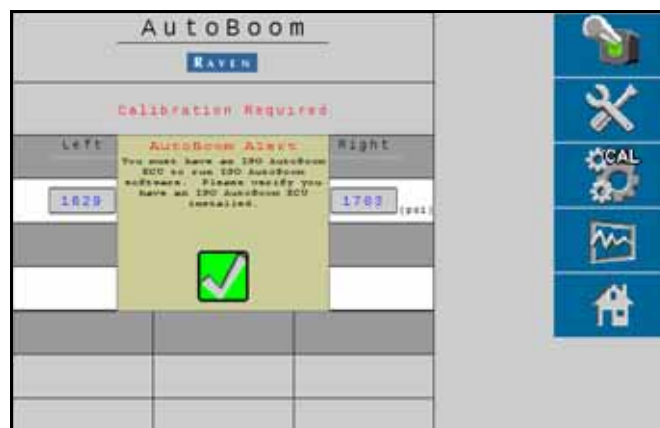
FIGURA 9. Solicitação de Nodo Incorreta
