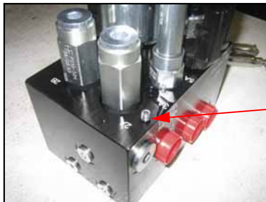
FIGURA 15. Conexões dos Orifícios Removidas da Válvula AutoBoom
