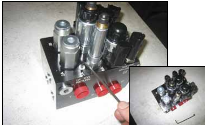
FIGURA 14. Bujões das Portas Removidos da Válvula AutoBoom
