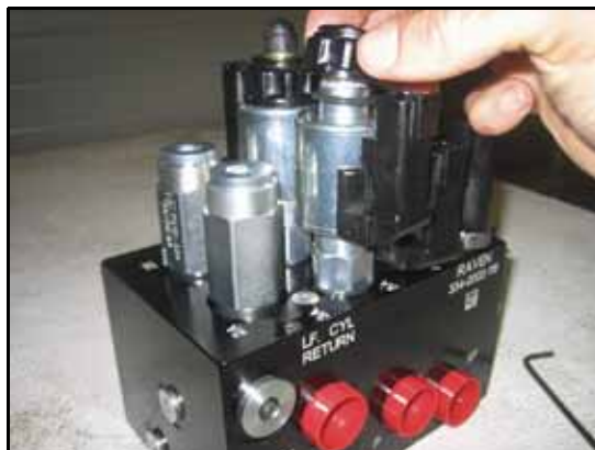
FIGURA 17. Bobina Reinstalada na Válvula AutoBoom
