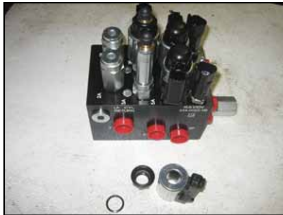
FIGURA 13. Bobina Removida da Válvula AutoBoom
