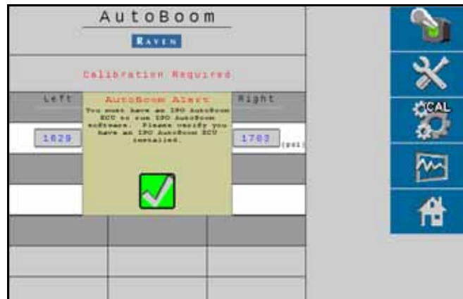
FIGURA 5. Solicitação de Nodo Incorreta
