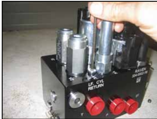
FIGURA 16. Bujão da Porta Reinstalado na Válvula AutoBoom
