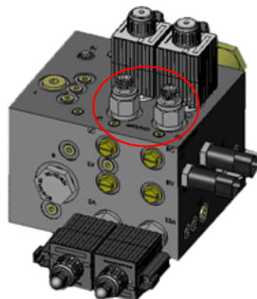
FIGURA 10. Válvulas de agulha na Válvula UltraGlide AutoBoom
