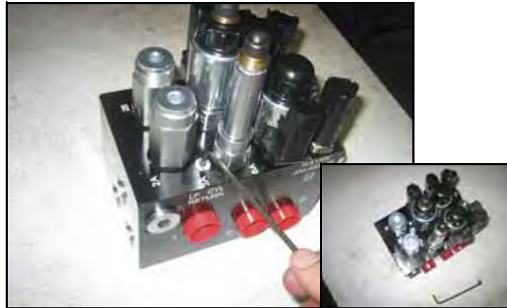
FIGURA 15. Dopurile porturilor îndepărtate din supapa AutoBoom
