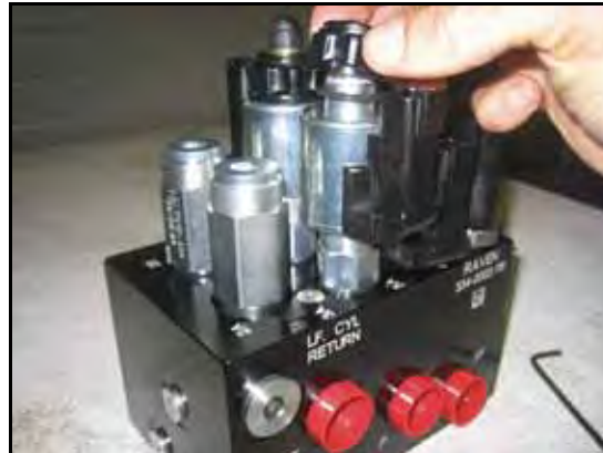
FIGURA 18. Bobină reinstalată la supapa AutoBoom
