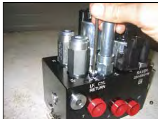
FIGURA 17. Dopurile porturilor reinstalate la supapa AutoBoom
