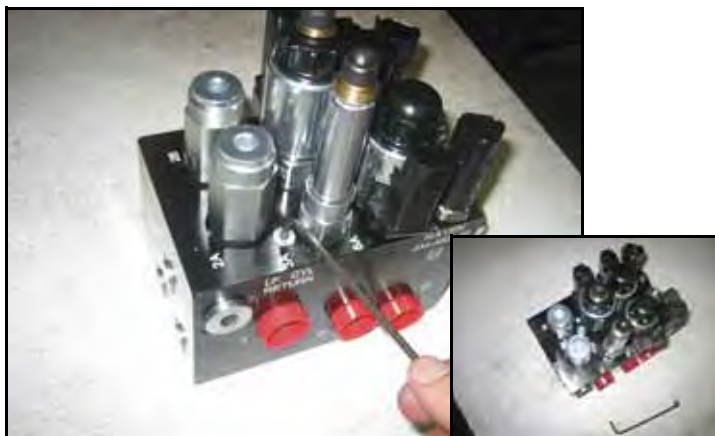
RYSUNEK 15. Zdemontowane wkładki złącz zaworu AutoBoom
