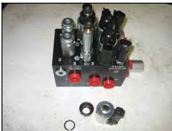
RYSUNEK 14. Zdemontowana cewka zaworu AutoBoom
