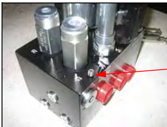
RYSUNEK 16. Zwężka zdemonstrowana z zaworu AutoBoom
