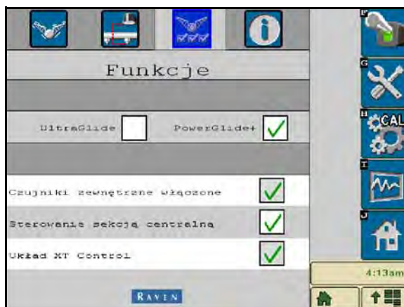
RYSUNEK 19. Zaprogramowanie terminala ISO do pracy w trybie PowerGlide Plus
