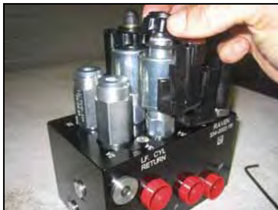
RYSUNEK 18. Cewka zamontowana do zaworu AutoBoom
