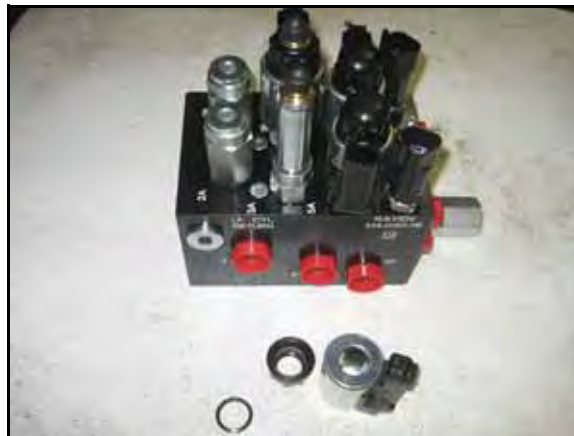
FIGUUR 14. Spoel verwijderd uit de AutoBoom-klep
