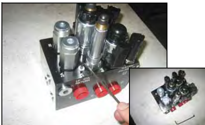
FIGUUR 15. Poortpluggen verwijderd uit de AutoBoom-klep
