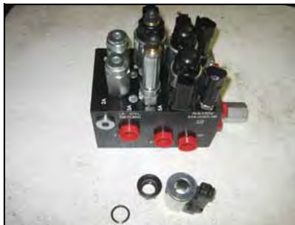
14 ÁBRA. Az AutoBoom szelepeiről eltávolított tekercs
