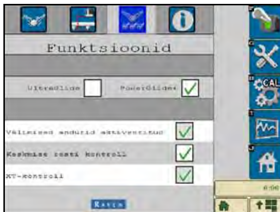
FIGURE 12. ISO-terminal programmeeritud PowerGlide Plus režiimil töötamiseks
