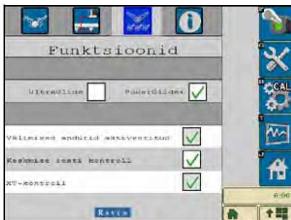
FIGURE 19. ISO-terminal programmeeritud PowerGlide Plus režiimil töötamiseks
