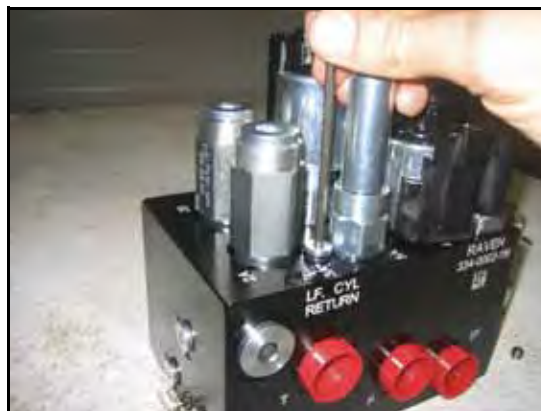
FIGURE 17. AutoBoomi klapiilt eemaldatud pordi korgid
