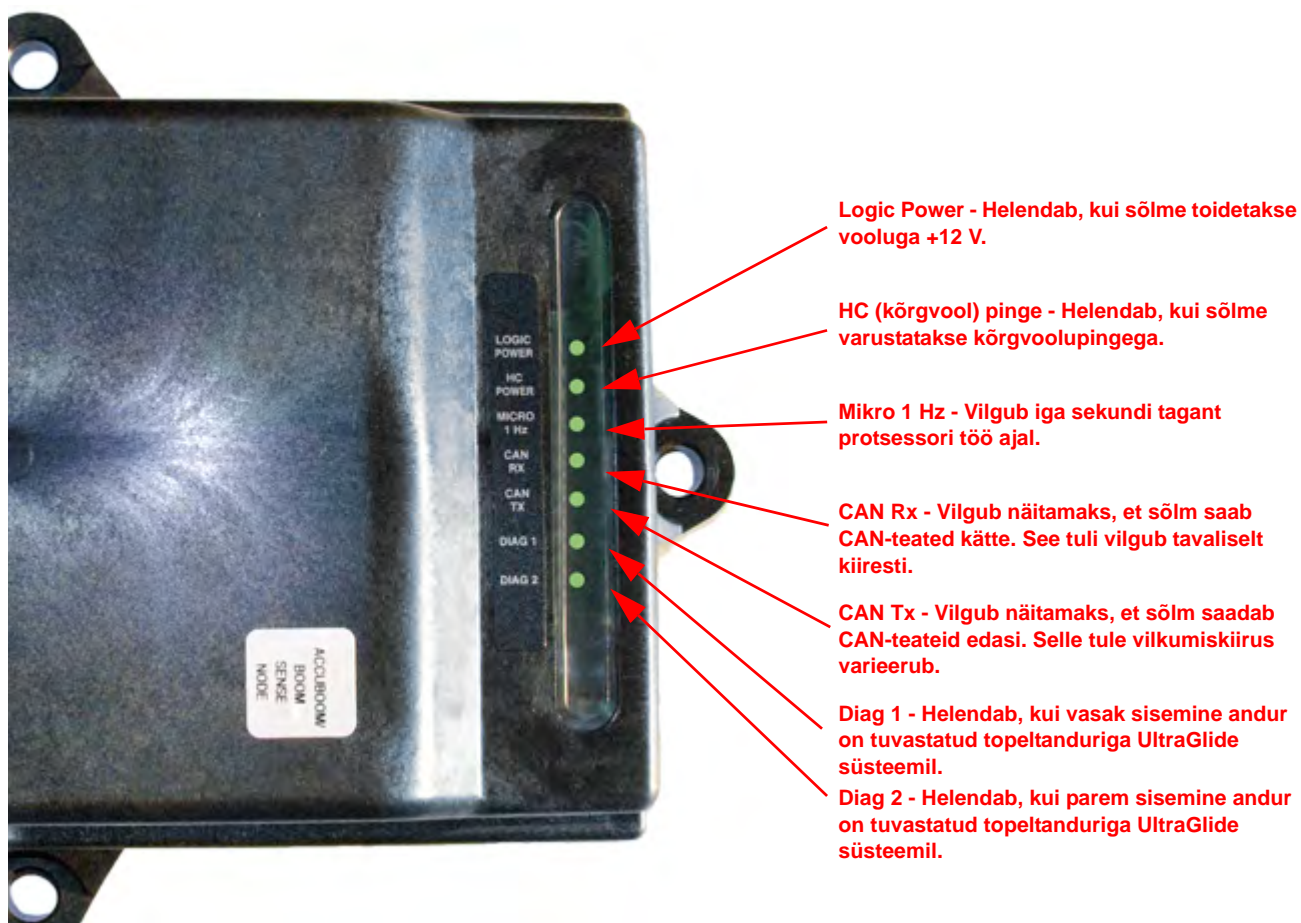
FIGURE 1. AutoBoom CAN-kontrolli sõlme leedlambid
