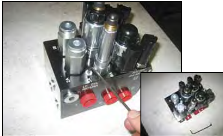
FIGURE 15. AutoBoomi klapiilt eemaldatud pordi korgid
