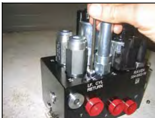
OBRÁZEK 17. Znovu nainstalovaná zástrčka portu na ventilu AutoBoom
