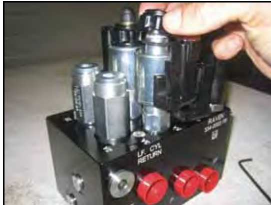
OBRÁZEK 18. Znovu nainstalovaná cívka na ventilu AutoBoom
