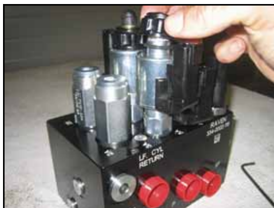
ФИГУРА 18. Монтирана намотка на клапана AutoBoom
