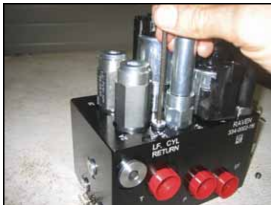
ФИГУРА 17. Монтирани капачки на портовете на клапана AutoBoom
