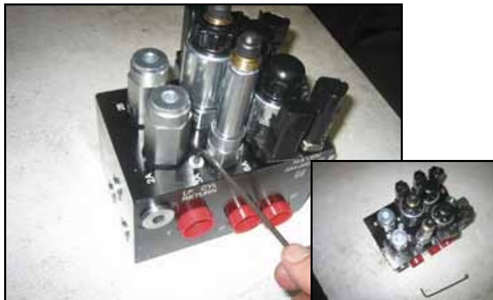
ФИГУРА 15. Извадени капачки на портовете на клапана AutoBoom
