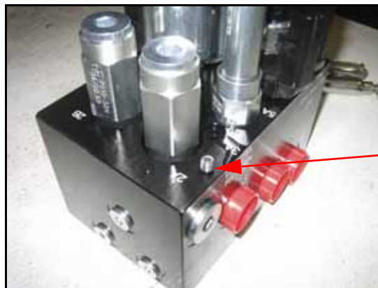
ФИГУРА 16. Извадени фитинги на отворите на клапана AutoBoom
