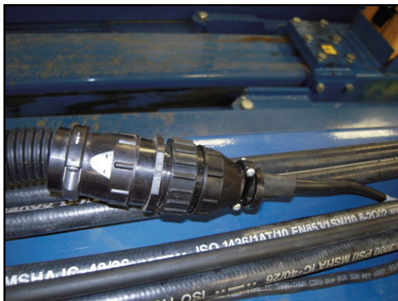
FIGURE 2. Подключение датчика семяпровода
