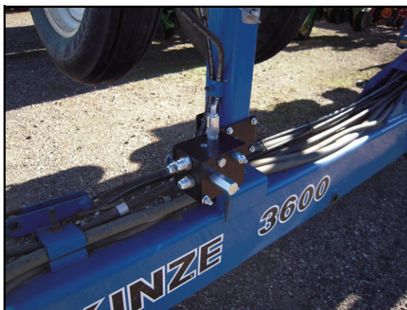
FIGURE 14. Установленный редукционный клапан с открытым центром
