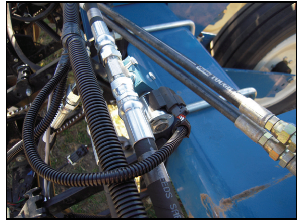
FIGURE 4. Подключения соединительного кабеля на модулях рядков
