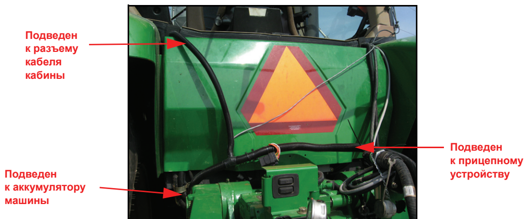
FIGURE 1. Удлинительный кабель, подсоединенный к жгуту проводов трактора
