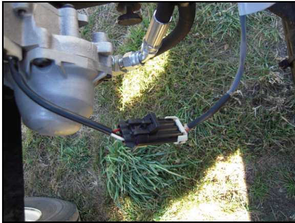
FIGURE 4. Подключения соединительного кабеля на модулях рядков
