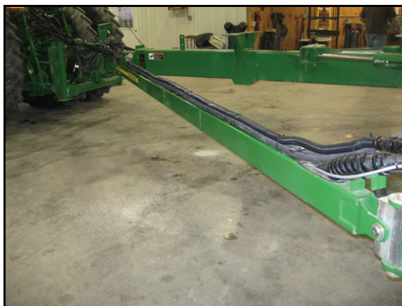
FIGURE 5. Удлинительный кабель, проведенный к прицепному устройству трактора
