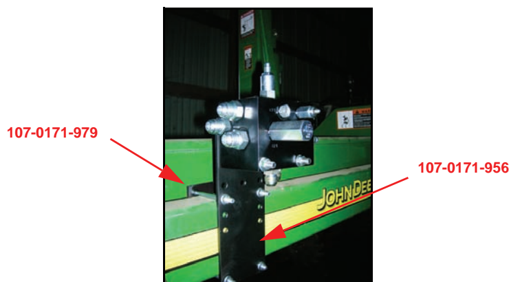
FIGURE 14. Установленный редуциционный клапан с открытым центром
