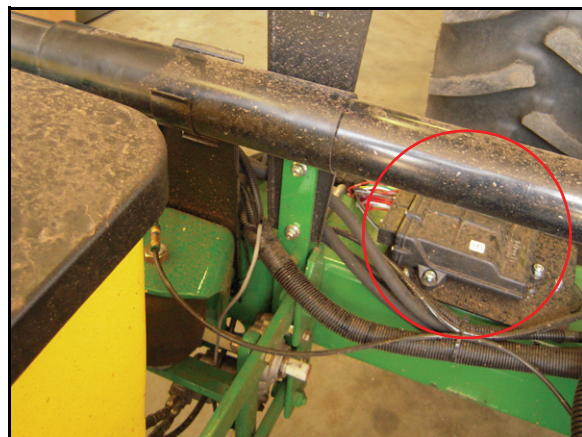
FIGURE 7. Установленный узел OmniRow
