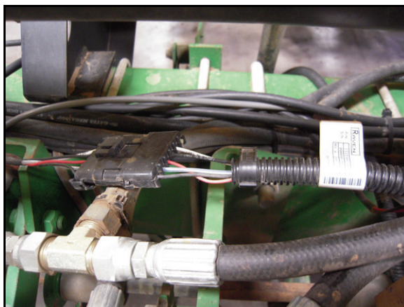
FIGURE 3. Соединение жгута проводов и соединительных кабелей
