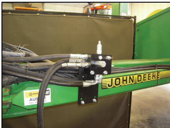
FIGURE 17. Установленные нагнетательные и сливные шланги редукционного клапана
