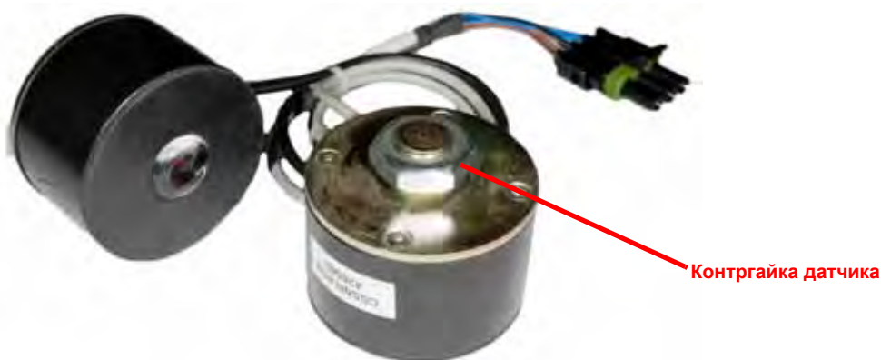
ИЗОБРАЖЕНИЕ 5. Сборка низкопрофильного датчика урожайности
