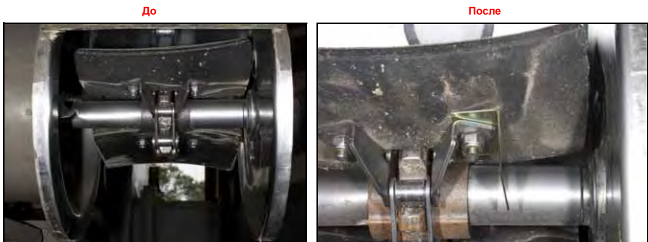
ИЗОБРАЖЕНИЕ 14. Примерный вид чистого зернового элеватора и лопастей
