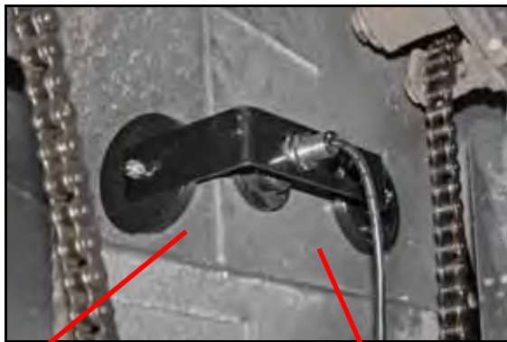
Рис. 3. Пример места монтажа датчика урожайности
