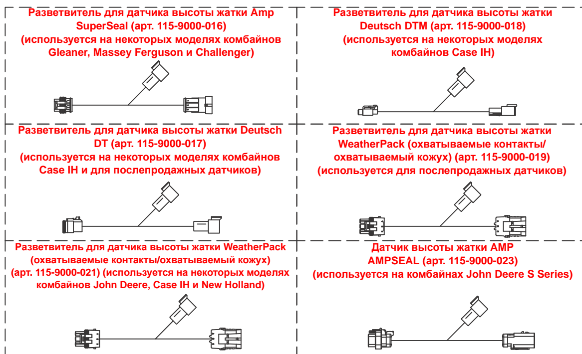
Рис. 1. Кабели-разветвители для датчиков положения жатки, установленных на заводе-производителе (арт. 054-9000-007)
