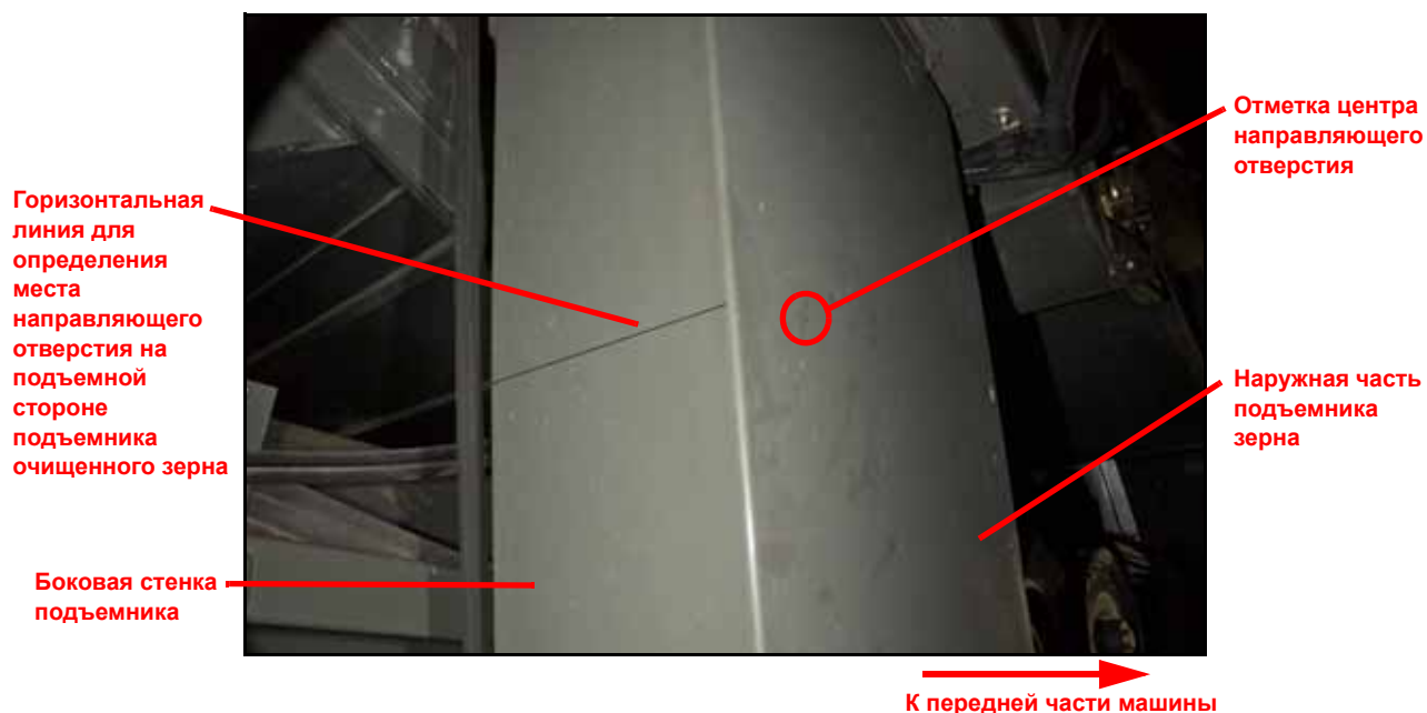
Рис. 4. Пример определения и разметки центров направляющих отверстий для датчиков урожайности
