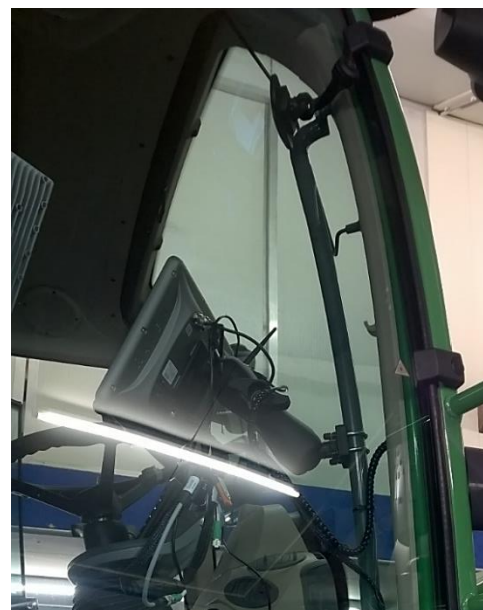
Figuur 15 Terminal aan ISO bevestiging A-stijl.
