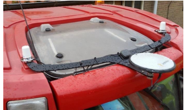
Figuur 13 CNH GPS-antenne bracket samen met een SlingShot antennekit.
