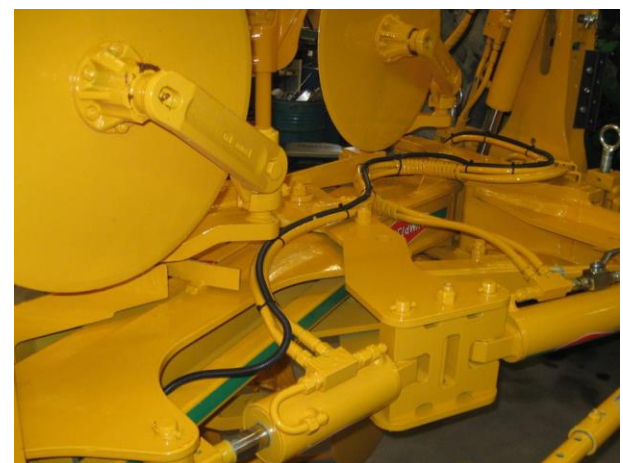
Figuur 12 Hoeksensorkabel met hydrauliekleidingen mee geleiden
