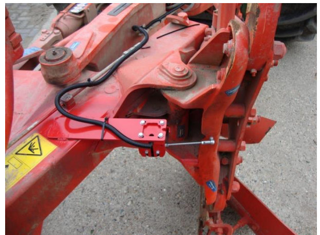
Figuur 4 Hoeksensor gemonteerd op ploeg zonder beweegbare ploegbreedte-framebalk
