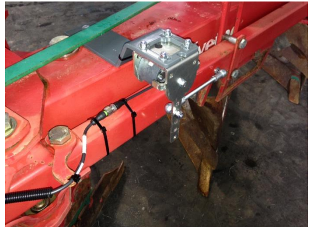
Figuur 3 Hoeksensor gemonteerd op beweegbare ploegbreedte-framebalk
