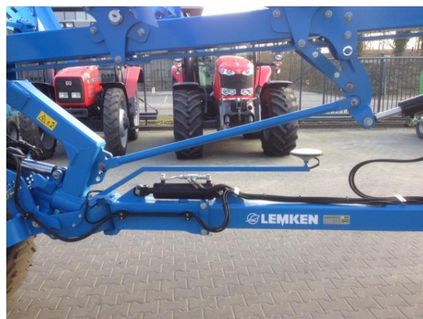
Figuur 13 GPS-antenne gemonteerd op halfgedragen wentelploeg in transportstand
