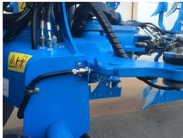
Figuur 11 Inductieve sensoren gemonteerd op driepuntsbok
