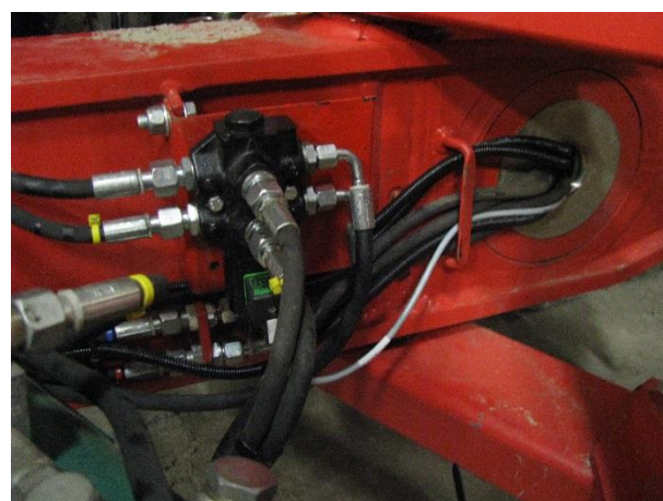
Figuur 23 6/2 stuurventiel gemonteerd tussen bestaande koppelingen
