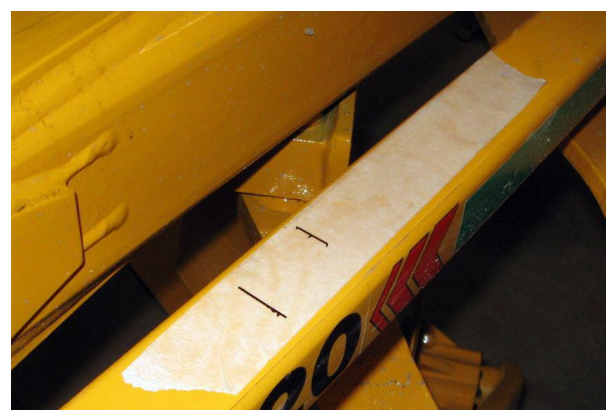
Figuur 5 Range van hoeksensor op breedte-framebalk
