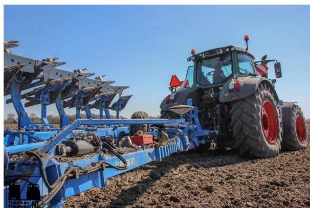
Figuur 14 GPS-antenne gemonteerd op halfgedragen wentelploeg in ploegstand
