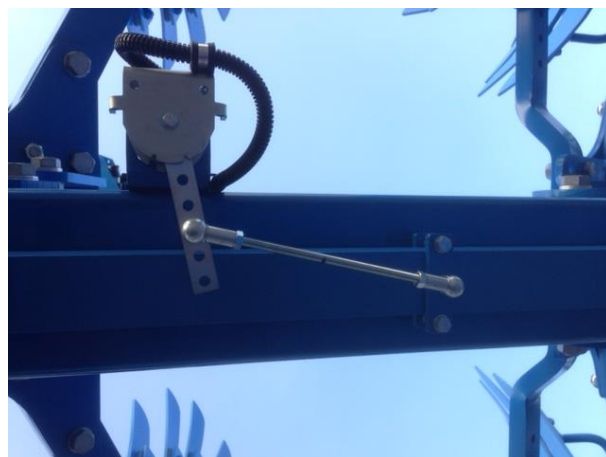
Figuur 3 Hoeksensor gemonteerd op ploeg met beweegbare ploegbreedte-framebalk
