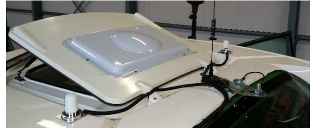
Figuur 9 Plaatsing antenne's op het dak
