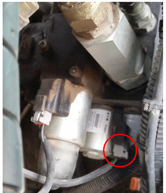
Figuur 5 Aansluiting van het harness STU – NH IntelliSteer op het CNH afsluitventiel.
