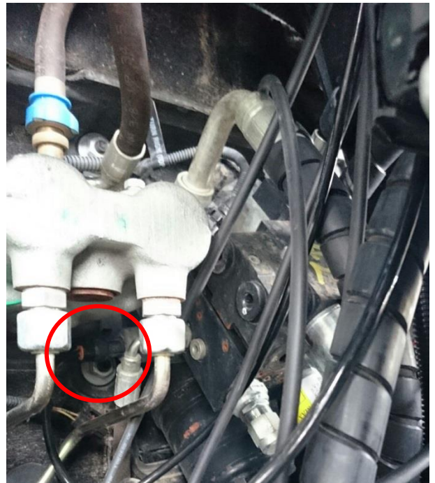
Figuur 6 Aansluiting van het Harness STU – NH IntelliSteer voor de druksensor.
