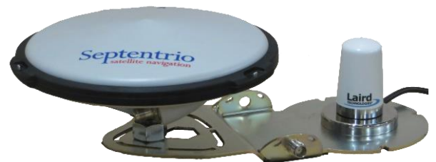
Figuur 14 GPS-antenne bracket samen met een GSM-antenne.
