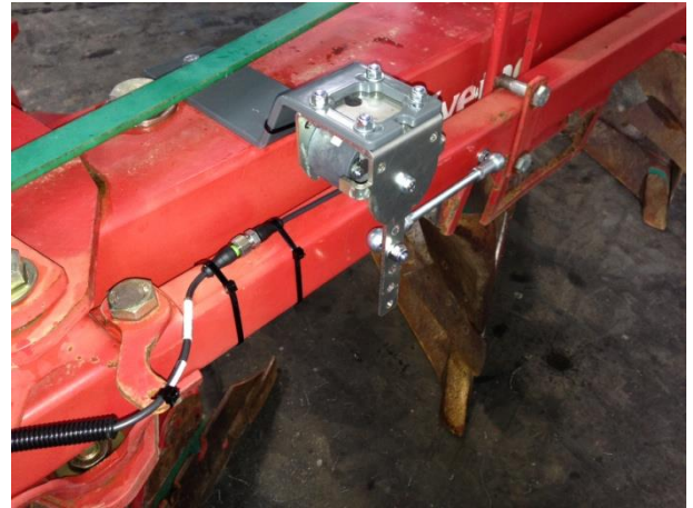
Abbildung 3 Winkelsensor montiert auf beweglichem Breiten-Rahmenbalken
