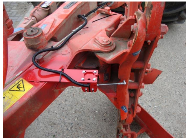
Abbildung 4 Winkelsensor montiert auf Pflug ohne beweglichen Pflugbreiten-Rahmenbalken
