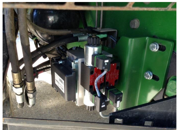
Abbildung 2 Montage Manifold und Steering Controller.
