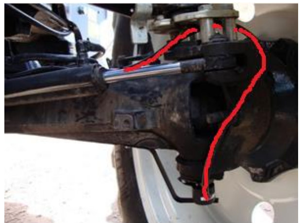
Abbildung 21 Kabel über Achsschenkel/Drehpunkt nach oben führen.
