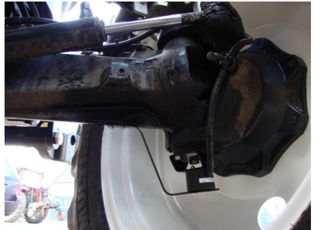
Abbildung 19 New Holland-Vorderachse mit Radsensor.
