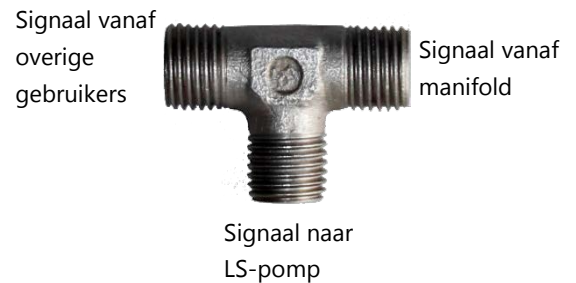
Figuur 5 Bovenaanzicht van wisselklep voor montage in de load-sense leiding.
