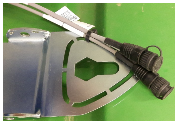
Figuur 44 Kabels naar de Raven 600S antenne.
