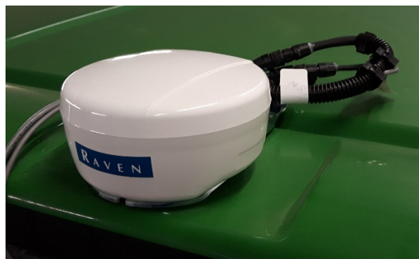
Figuur 43 Raven 600S antenne op een cabine.
